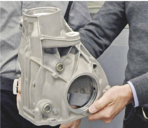
Die Unternehmer Martin Hirlinger (links) und Tobias Wenz präsentieren das bisher größte Bauteil, das in ihrem Spin-off 3D-Laserdruck additiv gefertigt wurde: ein Getriebegehäuse aus Aluminium für den Einsatz in einem Testfahrzeug der Mercedes E-Klasse. Bilder: Stauß
